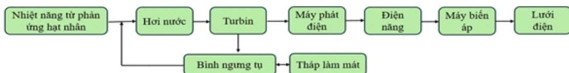
Hình 3. Sơ đồ khối quá trình sản xuất điện năng từ nhà máy điện hạt nhân.
