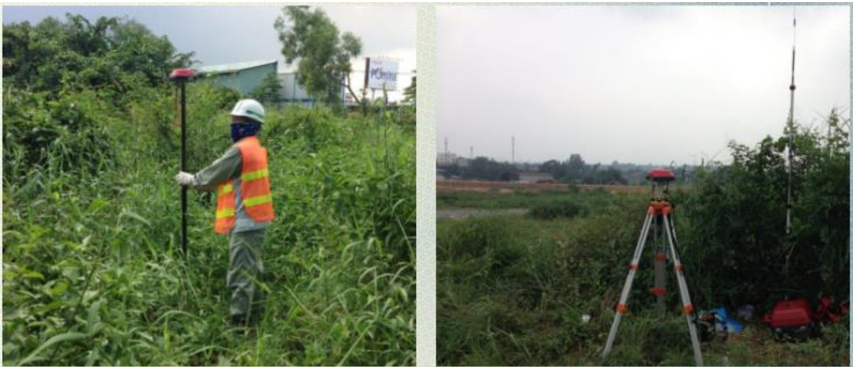
Hình A1.3.: Công tác đo RTK bằng máy GPS Pentax tại thực địa
