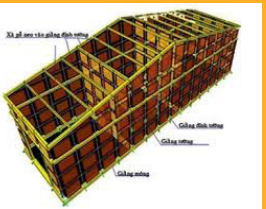
Kết cấu đòn tay mái tôn chống bão
