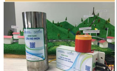
Gầu đo mưa và thiết bị đo vượt ngưỡng
