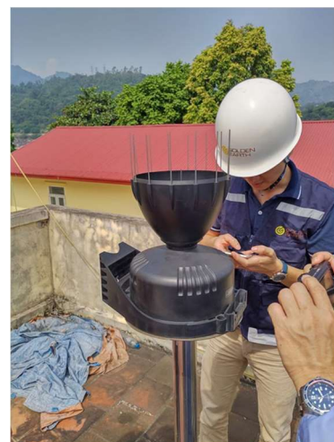
Trạm đo mưa tự động tại Chi cục TL Hòa Bình (09/2019)
